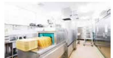
▲ ベルトコンベア式洗浄機(ドイツ製の省エネタイプ)が設置された洗浄室
